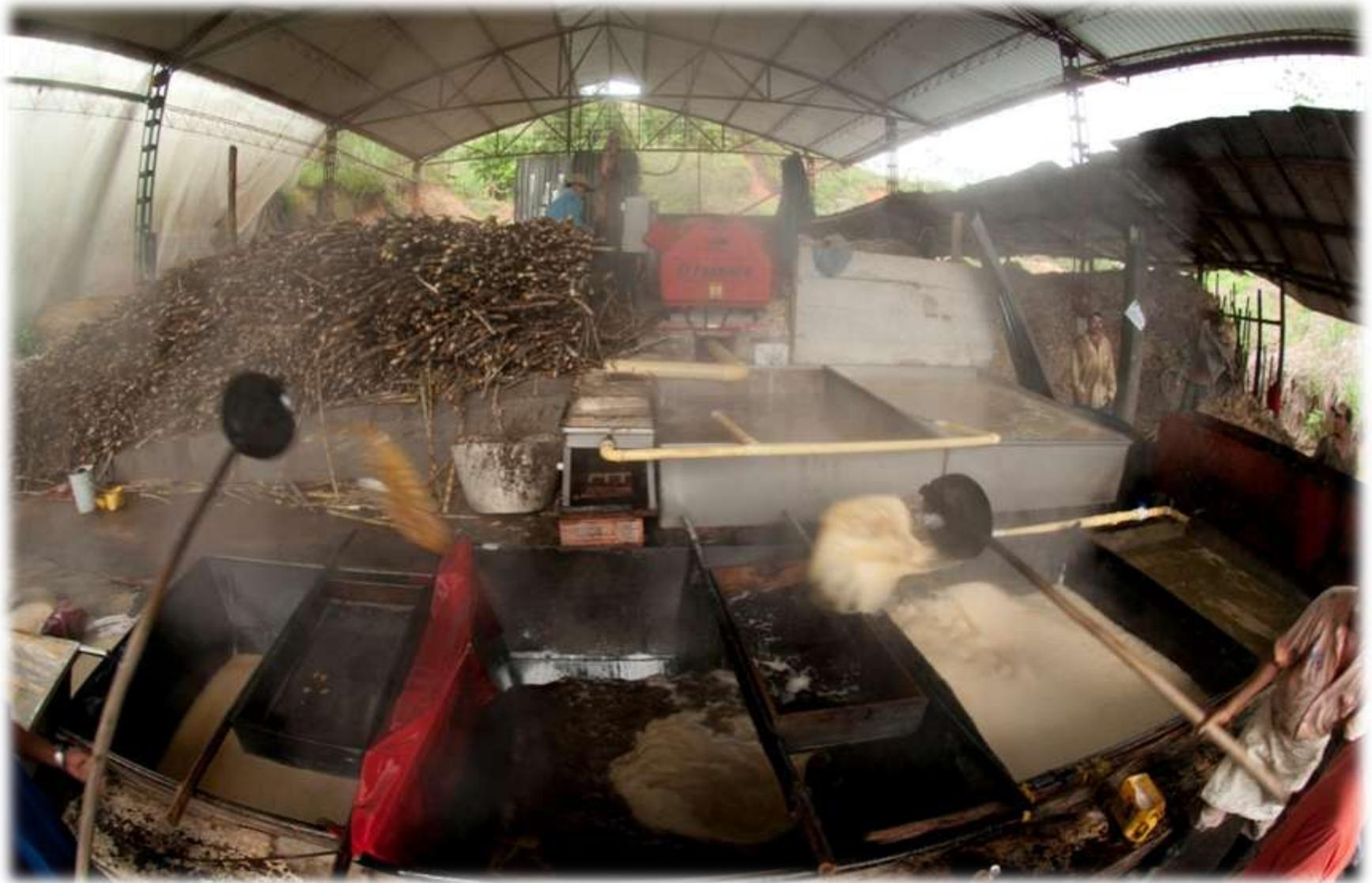
DESPUES DE PRENSAR LA CAÑA, EL JUGO ES RECIBIDO EN TANQUES PRELIMPIADORES DONDE POR GRAVEDAD SE HACE UNA PRIMERA LIMPIEZA. LUEGO EL JUGO ES COCINADO EN LAS PRIMERAS PAILAS DONDES SE LE SACA LA ESPUMA PARA LIMPIAR LAS IMPUREZAS. PARA PRODUCIR MAS ESPUMA SE LE ADICIONA UN AGLUTINANTE VEGETAL EXTRAIDO DE PLANTAS COMO EL BALSO Y EL CADILLO.
